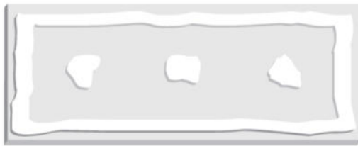
Incollaggio a cordolo perimetrale continuo e punti centrali (metodo ottimale)
