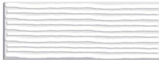
Incollaggio a tutta lastra con spatola dentata (metodo sconsigliato in caso di non ottimale planarità delle superfici)
